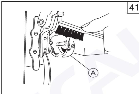
Удалите пыль и грязь вокруг вращающегося челнока (A), как показано на рисунке, а шпульный колпачок протрите мягкой тканью.
