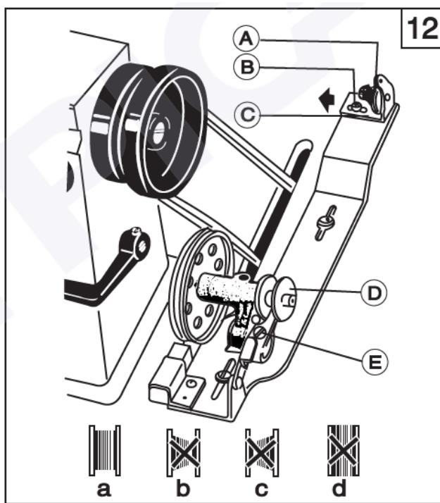
Нить должна быть равномерно и плотно намотана на шпульку. Если она наматывается не плотно, Вы можете увеличить давление на зажимную пластину крепежа (А). Если намотка неравномерная, необходимо пошевелить катушку (С) для регулировки ее положения. При регулировке, сначала ослабьте винт катушки (В), если нить наматывается только с одной стороны, как показано на рисунке 12 (b), подвиньте катушку
