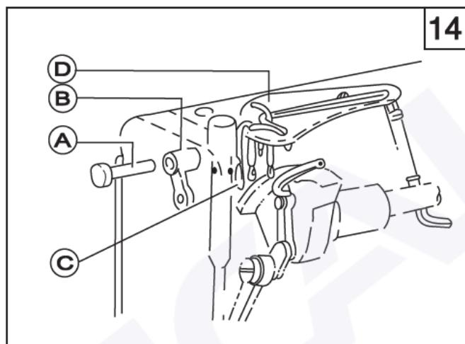
Для подачи масла в игловодитель и нитепрятгиватель используется мягкая нить из овечьей шерсти. После длительного использования, при прекращении нормальной подачи масла, мягкая (масляная) нить загрязнилась или затвердела, поэтому ее необходимо заменить на новую, заменить можно следующим образом:
