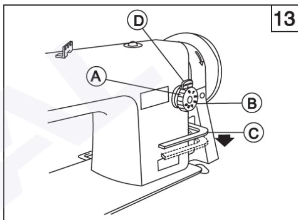
Длину стежка можно отрегулировать, поворачивая колесо регулировки длины стежка (А). При вращении против часовой стрелки, длина стежка будет увеличиваться; при вращении по часовой стрелке, длина стежка будет уменьшаться. Цифры на передней поверхности (В) колеса (А) показывают длину стежка (единица измерения: мм). Примечание: регулируя длину стежка, необходимо зажать кнопку длины стежка (Д), а после завершения регулировки, отпустить, чтобы он вернулся в исходное положение.
