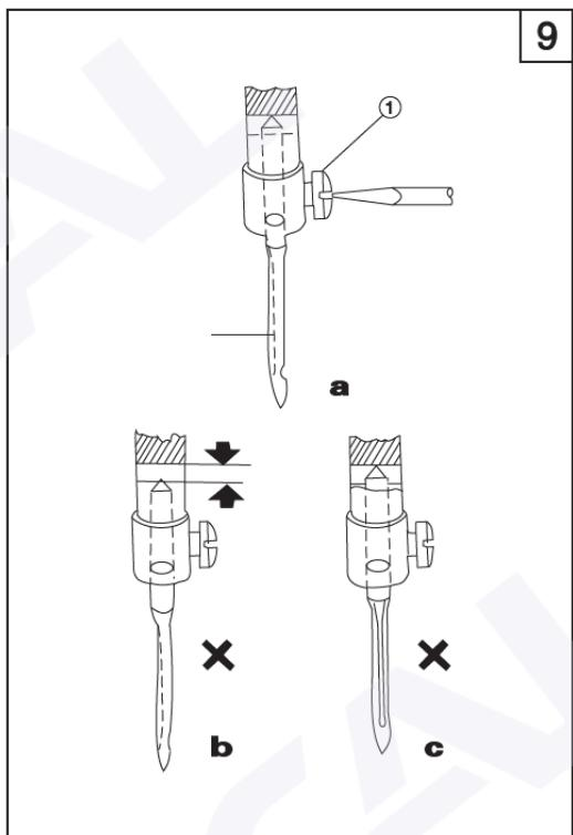
Поверните маховое колесо так, чтобы игловодитель поднялся в максимальное верхнее положение, ослабьте прижимной винт игры ①, длинный паз игры должен быть слева от оператора. Вставьте иглу в отверстие для игры в нижней части игловодителя, а затем затяните прижимной винт игры ①, чтобы зафиксировать ее.
