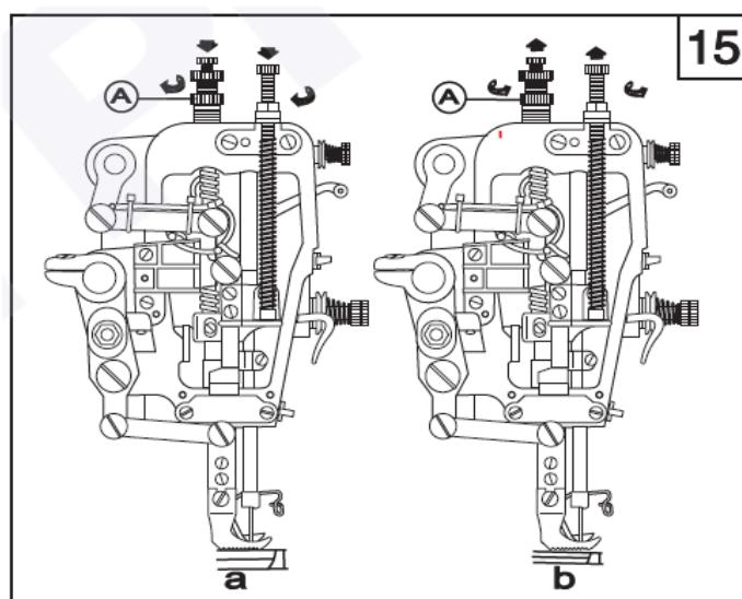
рисунке *b*, чтобы снизить давление прижимной лапки. В конце, затяните стопорную гайку винта регулировки давления (A).
