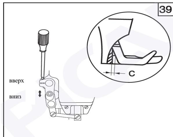
Метод регулировки: сначала ослабьте винт переднего коленчатого вала, а затем поверните ось вверх, тогда шагающая прижимная лапка приблизится к игловодителю. В процессе регулировки, обращайте внимание на заданную величину зазора С.
