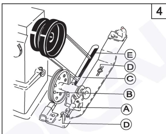
После установки головки машины и ремня, можно приступить к установке устройства намотки. Во время установки устройства намотки, сначала выровняйте намоточное колесо, (B) по внешней стороне ремня (C), между намоточным колесом и ремнем должен быть определенный зазор, а также убедитесь, что намоточное колесо и ремень могут соприкасаться, когда кулиса (A) прижата книзу. Таким образом, при работе машины, ремень будет вращаться вместе с катушкой. Также обратите внимание на положение
